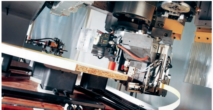
Die Funktion Kantenanleimen ist eine automatisiert austauschbare mechatronische Komponente. Foto: Homag
